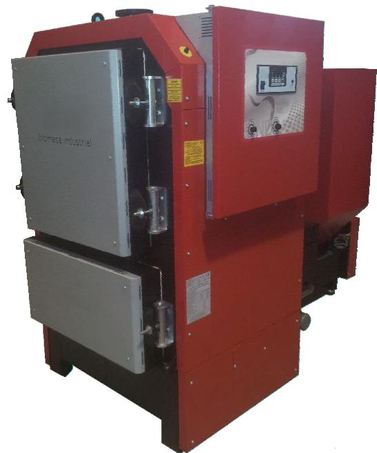
Esta gama de calderas está disponible en las siguientes potencias: 100, 150, 225, 300, 400, 500, 650, 800 y 950 kw. El funcionamiento de esta caldera es con un quemador de floración, realizado en fundición, que es alimentado por un sifón desde la parte trasera (para potencias de 100 a 500 kw inclusive), o desde la parte lateral (para potencias 650, 800 y 950 kw).
