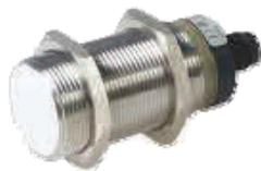
Detector de nivel mínimo de combustible en tolva para modelo DO, con regulación de sensibilidad. Ø32mm con conector de Ø18mm acodado. En caso de falta de combustible bloquea la caldera evitando vaciar el sifón de combustible y un posible retroceso de humo por la tolva.
