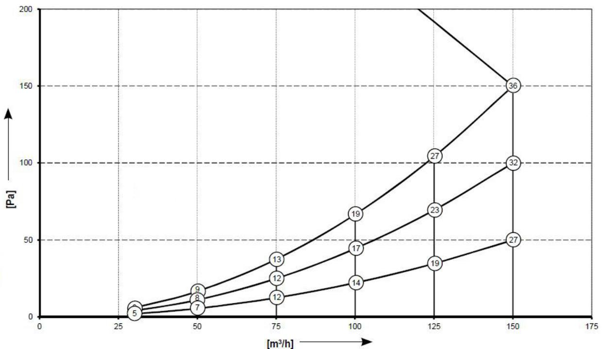
Los números que contienen los círculos indican la potencia por ventilador [en W].
