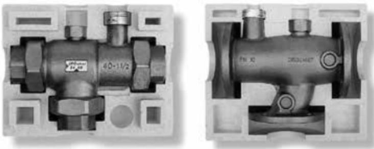
Les emballages pour le transport des mitigeurs thermostatiques JRGUMAT LF servent d'isolation thermostatique après la pose et le réglage du mitigeur et peut être obtenu comme pièce de rechange si nécessaire.
