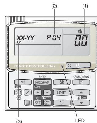
**\*2:** Display de 7 segmentos de 4 dígitos para display del mando a distancia
