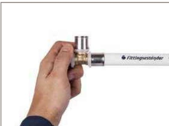
El accesorio de la medida adecuada debe introducirse en la tubería, con el casquillo puesto en su junta y girándolo suavemente hasta que se visualice la tubería en los testigos dispuestos en el casquillo.
