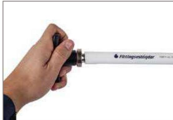
Introducir el calibrador en el tubo hasta el tope de la sección correspondiente al diámetro de la tubería. Girarlo en el sentido de las agujas del reloj y comprobar que el biselado se ha realizado correctamente.
