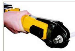
5. Prensado del tubo y accesorio. Utilizar mordazas de perfil "U".
