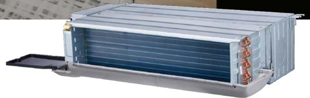
Unidades de conductos de baja presión para instalación en horizontal a 2 tubos. Estructura en chapa galvanizada con batería de agua de 3 filas y filtro de aire metálico. Versión con electrónica provista de salidas modbus y xye con posibilidad de conectar cualquier mando de mercado con entrada para gestión de velocidades del ventilador (H/M/L).
