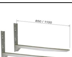
850 / 1100 | C-167                      | E0029  | 1100X600X60X3 | Soporte de lateral - <b>GRANDE</b> . Palas apoyo equipo 1100mm de longitud. Fabricado en chapa de acero de 3mm espesor. Carga máxima 100kg. Cartelas de refuerzo de 2mm espesor. B                                                                                                                                                         | 7.92          | 35.84 €           |
