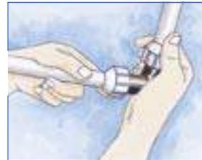
2. Inserte el final de la tubería de polietileno en el adaptador y apriete la tuerca de compresión.
