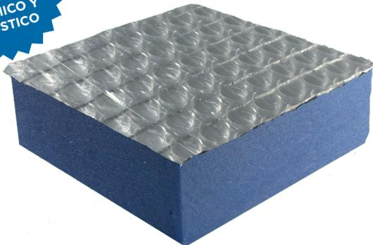
Sistema aislante termo-acústico reflectivo compuesto por una lámina de aluminio encerrada por una capa de burbuja de aire seco estanco y de una plancha de Poliestireno Extruido (Air-bur XPS) El sistema es suministrado por separado, para su instalación in-situ.
