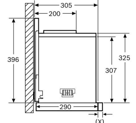
Montaje en aparatos con bastidor de descenso - profundidad del cuerpo del mueble conforme a la tabla de combinaciones
