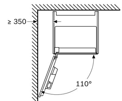
Si se utiliza el limitador de bisagra de 92°, la distancia mín. hasta la pared es de solo 100 mm
