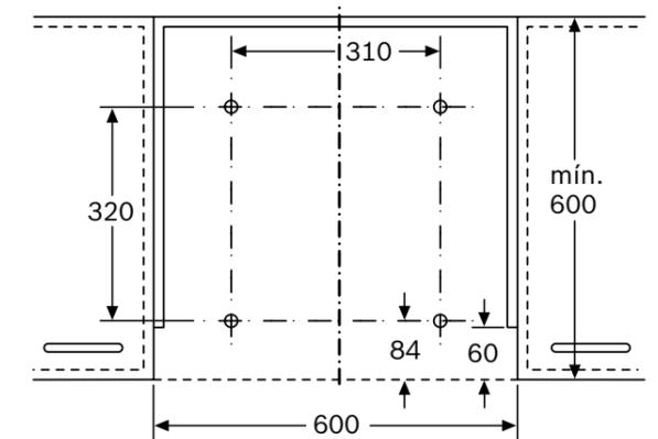
Montaje del aparato con bastidor de descenso
