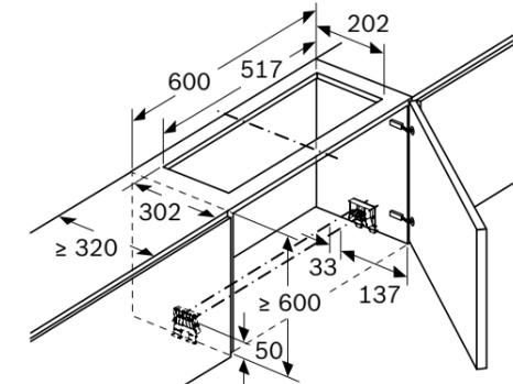
No se puede utilizar el juego de recirculación de aire en armarios con barra transversal (puerta abatible)
