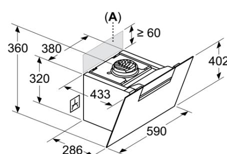
El enchufe puede instalarse en el costado o en la parte superior del aparato
