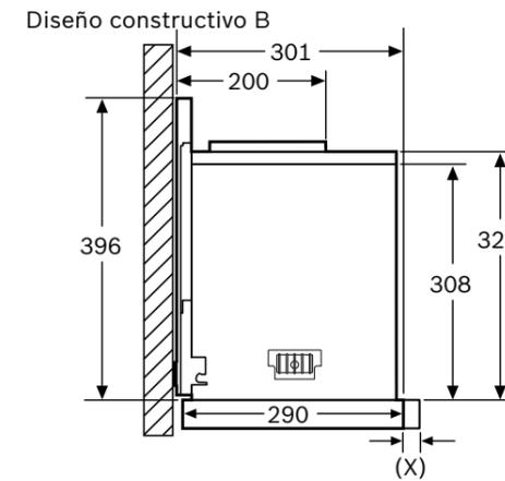
Montaje en aparatos con bastidor de descenso - profundidad del cuerpo del mueble conforme a la tabla de combinaciones
