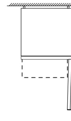
En caso de que se coloque el aparato directamente en la pared, todos los cajones pueden extraerse del todo tanto para modelos con tirador integrado como con tirador externo.
