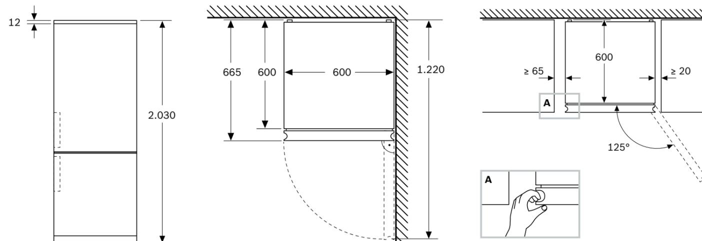
En caso de que se coloque el aparato directamente en la pared, todos los cajones pueden extraerse del todo tanto para modelos con tirador integrado como con tirador externo.
