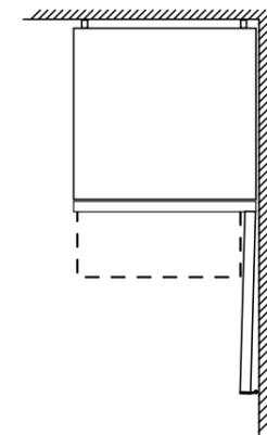
En caso de que se coloque el aparato directamente en la pared, todos los cajones pueden extraerse del todo tanto para modelos con tirador integrado como con tirador externo.
