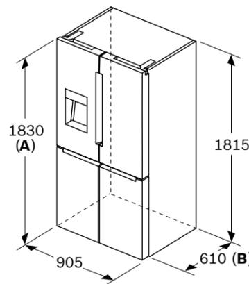
**A:** La parte frontal es ajustable desde 1830-1847 mm, con las patas de nivelación totalmente extendidas
