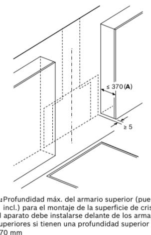
A: Profundidad máx. del armario superior (puerta incl.) para el montaje de la superficie de cristal. El aparato debe instalarse delante de los armarios superiores si tienen una profundidad superior a 370 mm
