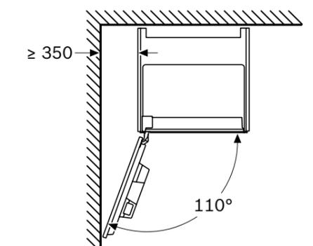
Si se utiliza el limitador de bisagra de 92°, la distancia mín. hasta la pared es de solo 100 mm
