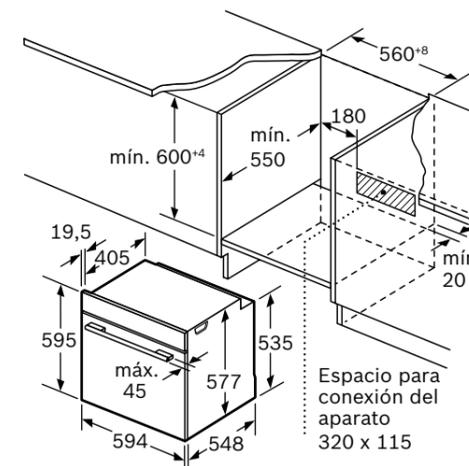
Si se instala el aparato debajo de una placa, se debe respetar el siguiente grosor de encimera (incl., dado el caso, la estructura de soporte).
