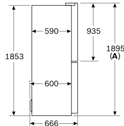
**A:** La parte frontal es ajustable desde 1895-1910 mm, con las patas de nivelación totalmente extendidas
