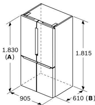
**A:** La parte frontal es ajustable desde 1.830 hasta 1.847, con las patas de nivelación totalmente extendidas
