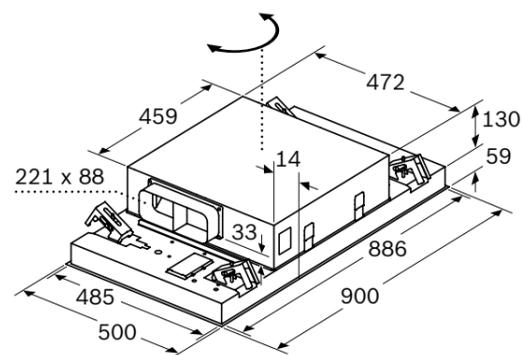
La salida del ventilador se puede girar en las cuatro direcciones
