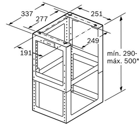
\* Altura regulable en intervalos de 20 mm
