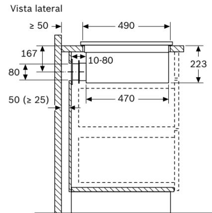
Al realizar la instalación directamente en paredes exteriores no aisladas ( $\mu \geq 0,5 \text{ W/m}^2 \text{ } ^\circ\text{C}$ ), recomendamos el uso de configuraciones de recirculación total o parcialmente canalizada.
