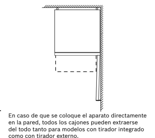
En caso de que se coloque el aparato directamente en la pared, todos los cajones pueden extraerse del todo tanto para modelos con tirador integrado como con tirador externo.
