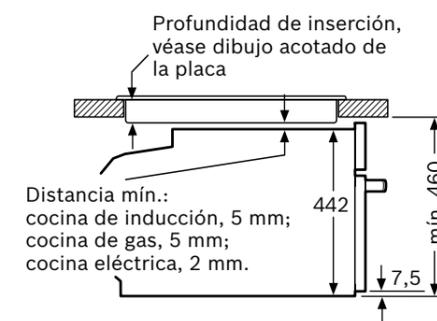
Si se instala el aparato debajo de una placa, se debe respetar el siguiente grosor de encimera (incl., dado el caso, la estructura de soporte).
