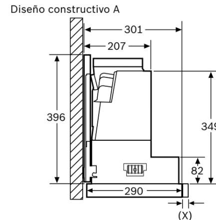
Montaje en aparatos con bastidor de descenso - profundidad del cuerpo del mueble conforme a la tabla de combinaciones
