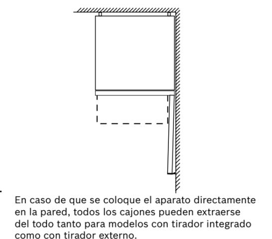
En caso de que se coloque el aparato directamente en la pared, todos los cajones pueden extraerse del todo tanto para modelos con tirador integrado como con tirador externo.
