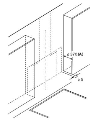
**A:** Profundidad máx. del armario superior (puerta incl.) para el montaje de la superficie de cristal
