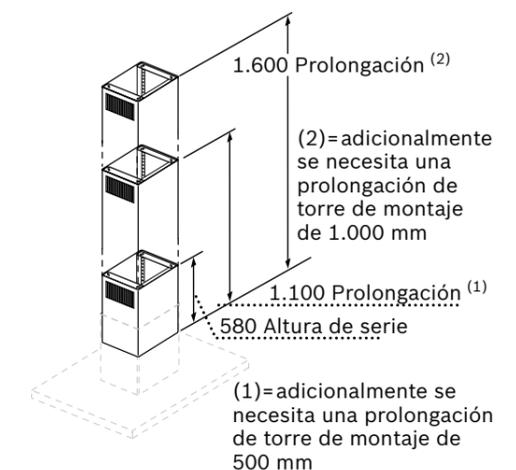
(2)= adicionalmente se necesita una prolongación de torre de montaje de 1.000 mm
