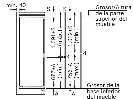
Las dimensiones dadas de la puerta del mueble corresponden a una junta de puerta de 4 mm.
