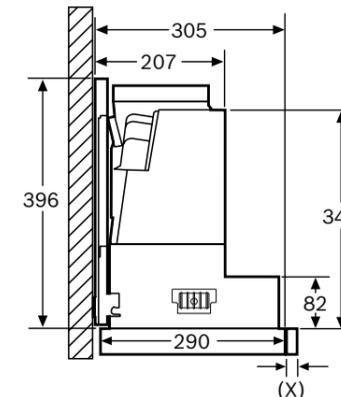
Montaje en aparatos con bastidor de descenso - profundidad del cuerpo del mueble conforme a la tabla de combinaciones
