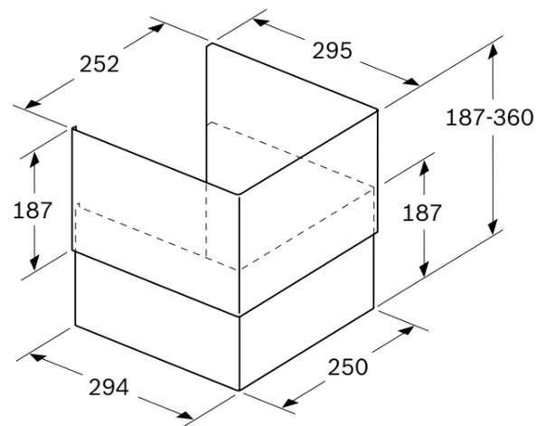
Ejemplo de montaje para altura de armario de 366-525 mm
