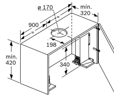
Para el montaje de la campana telescópica de 90 cm en un armario superior de 90 cm de anchura, es necesario un juego de montaje. Ambas escuadras de montaje se atornillan al mueble a derecha e izquierda. Montaje según plantilla.
