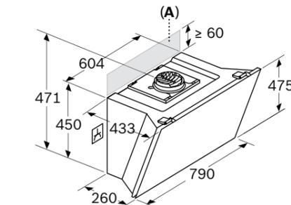
El enchufe puede instalarse en el costado o en la parte superior del aparato
