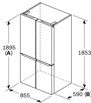
**A:** La parte frontal es ajustable desde 1895-1910 mm, con las patas de nivelación totalmente extendidas
