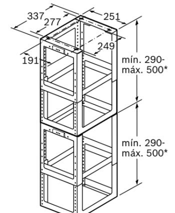
\* Altura regulable en intervalos de 20 mm
