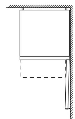
En caso de que se coloque el aparato directamente en la pared, todos los cajones pueden extraerse del todo tanto para modelos con tirador integrado como con tirador externo.
