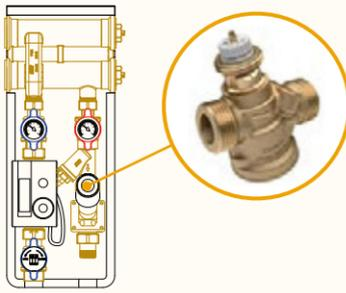
Con válvula de equilibrado dinámico
