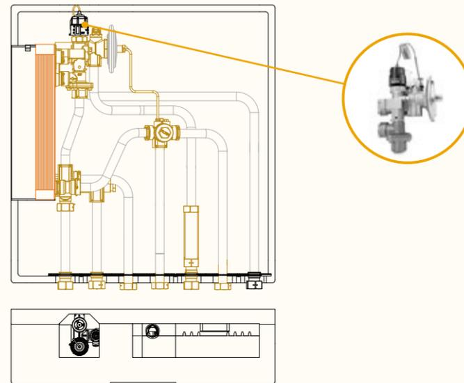
Con intercambiador de placas (configurado en caja)
