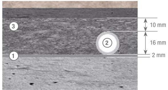
El sistema autofijación de bajo perfil ALB para rehabilitación está compuesto por una lámina autofijación basada en la tecnología tipo velcro de 2 mm de grosor. El tubo multicapa SUPERFLEX autofijación queda fijado a la misma gracias a la cinta que lo envuelve. El tubo SUPERFLEX, asimismo, posee una gran capacidad de flexibilidad y, por lo tanto, facilidad
