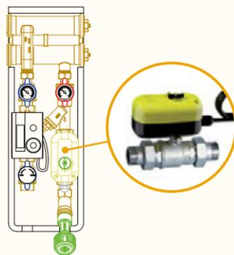
Con válvula de esfera motorizada (2 y 3 vías)
