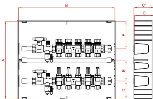
Colector ALB caudalímetro en caja de plástico
