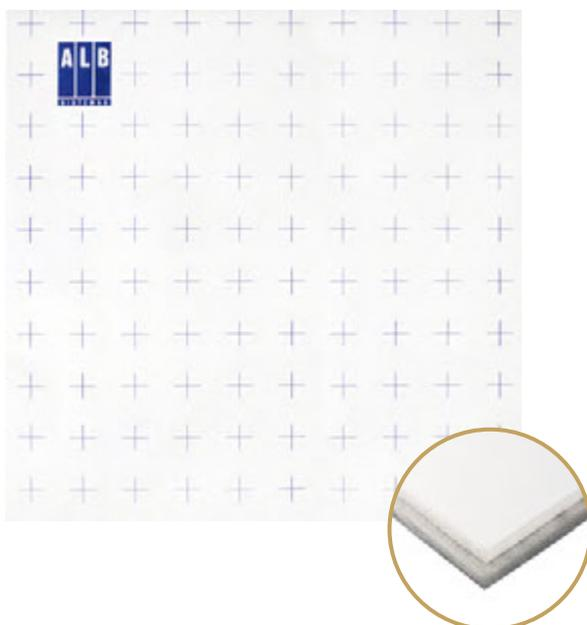
Panel aislante industrial ALB liso solapado, fabricado en poliestireno expandido (EPS), autoextinguible (Euroclase E) de 30 mm de grosor, cubierto por una lamina superficial de plástico provisto de solapas para unión entre paneles y cuadrícula de guía serigrafiada.
