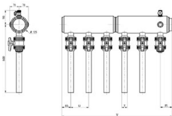
Colectores modulares fabricados en base a polietileno de alta densidad PE100 para conexión de sondas Ø40 (verticales) fabricadas en PE100 y con relación de diámetros SDR11. Conexión de dichas sondas mediante termofusión HS. Dotado de válvulas de bola. Incluye purgador R 1/2" y llave de llenado/vaciado. Dispone de dos orificios con rosca R1/2" con tapones para alojamiento de accesorios (p. ej. termómetro).
