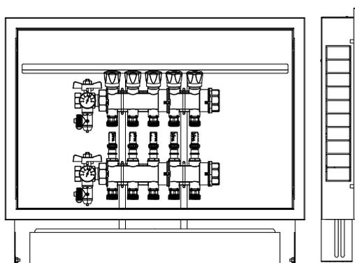
Colector ALB ULTRACOMPACTO 2+3 en caja metálica
