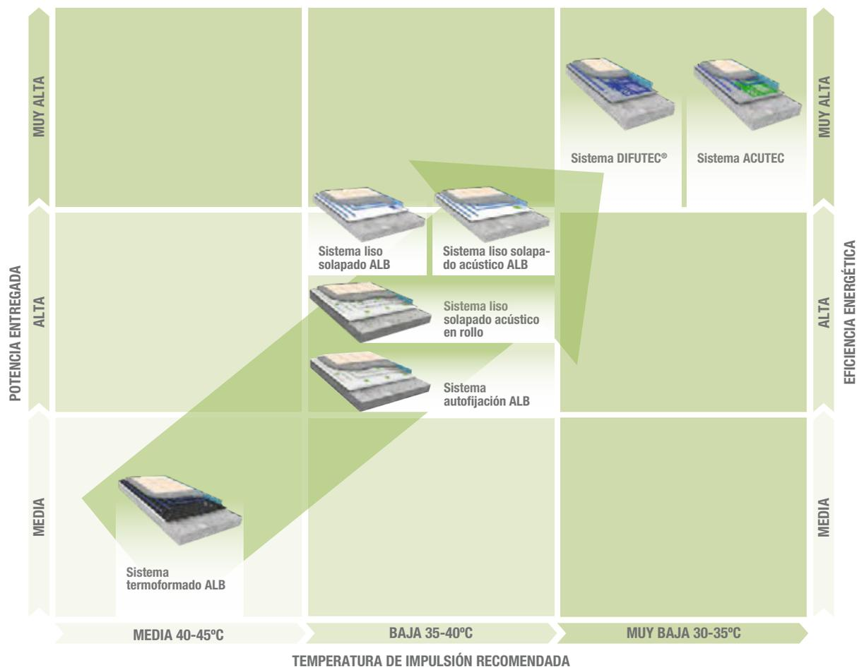
Gracias a la lámina difusora del calor, los sistemas ALB-DIFUTE<sup>®</sup> y ALB-ACUTE<sup>®</sup> tienen la máxima potencia entregada y requieren la mínima temperatura de impulsión, siendo la combinación perfecta para las bombas de calor.
