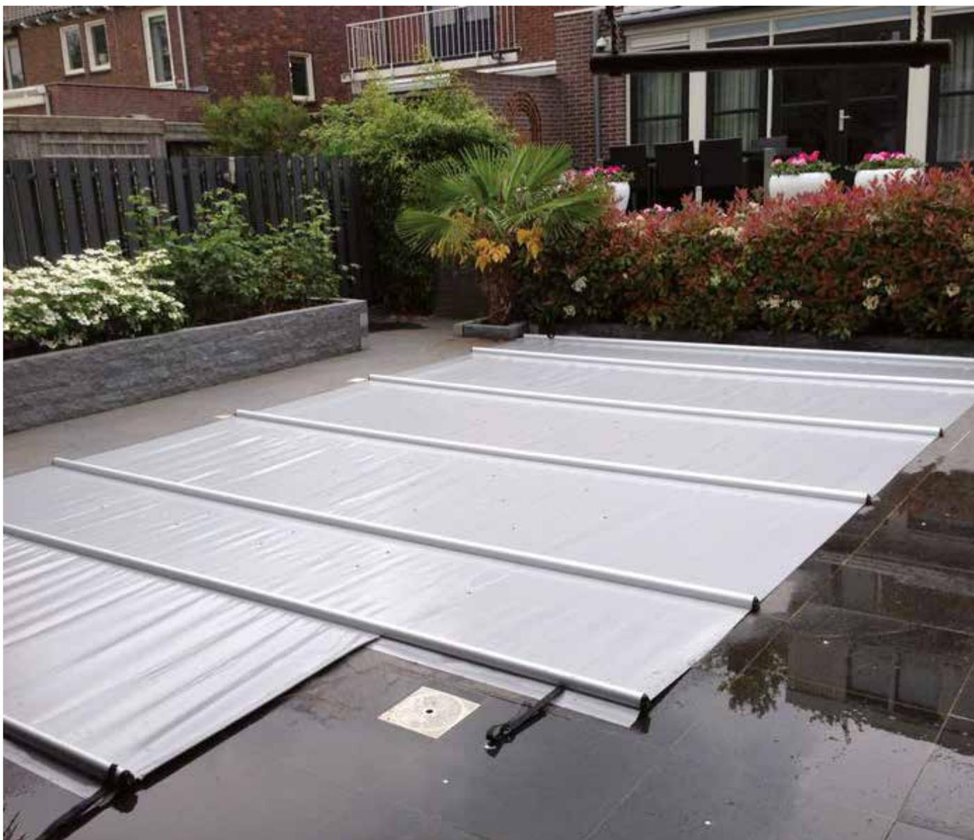
La cubierta de barras CBE-650 está fabricada de un tejido de poliéster altamente resistente recubierto de PVC (650 g / m<sup>2</sup>). Ambas superficies con tratamiento anti-UV. La tela de la cubierta es continua incluso bajo las barras, para una mayor resistencia y durabilidad.
