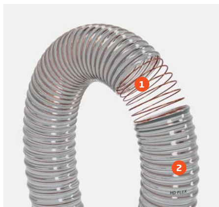
1. Espiral de acero cobreado. 2. Poliuretano transparente base poliéter.
