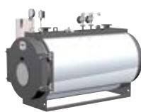
PREX N ASL 1.000 - 3.500 kW Caldera para agua sobrecalentada hasta 145 °C, con tres pasos de humo, dos de ellos en la cámara de combustión.
