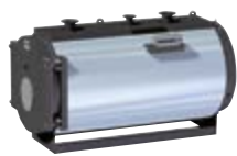
RSW N RSH N 2360 - 6000 kW / 1850 - 3000 kW Caldera para agua caliente con tres pasos de humo, dos de ellos en la cámara de combustión
